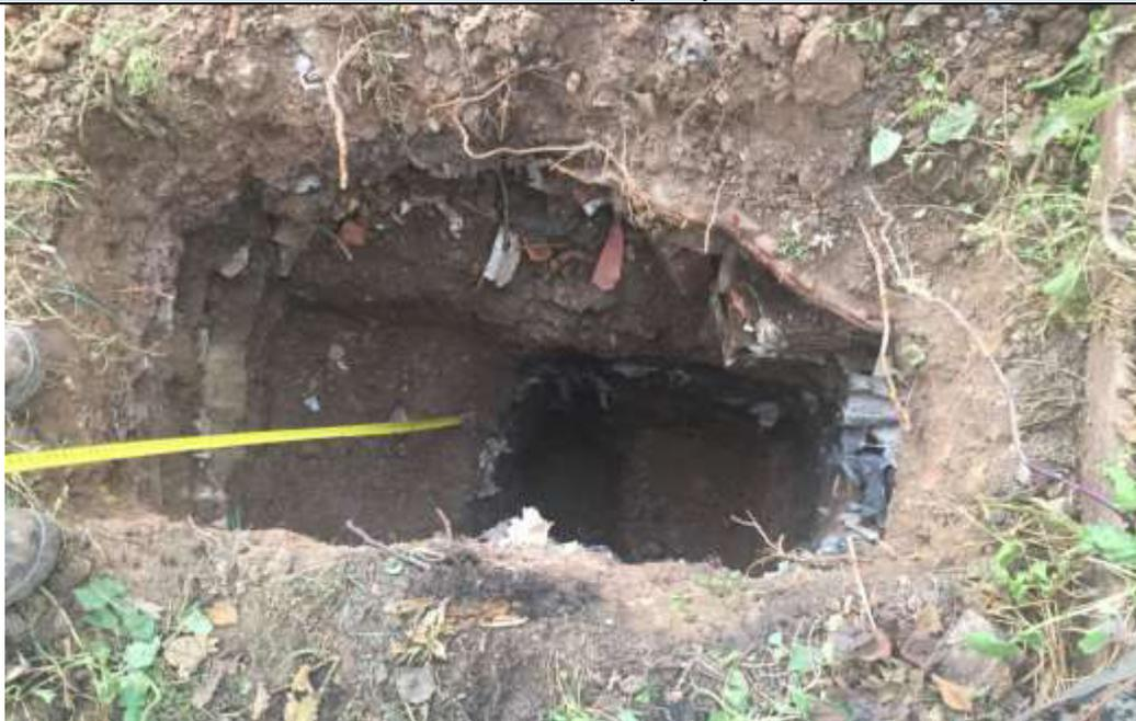
En los 1.5 m de exploración de la trinchera se encontró aproximadamente 1.100 de material de relleno contaminado con plástico y escombro, seguido por 0.5 metros de arcilla.
