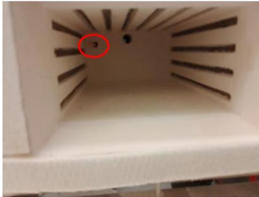
En la ficha técnica compartida especifica que todo el material interno del horno de la mufia es el fibra de cerámica, incluyendo el sensor tipo K.
