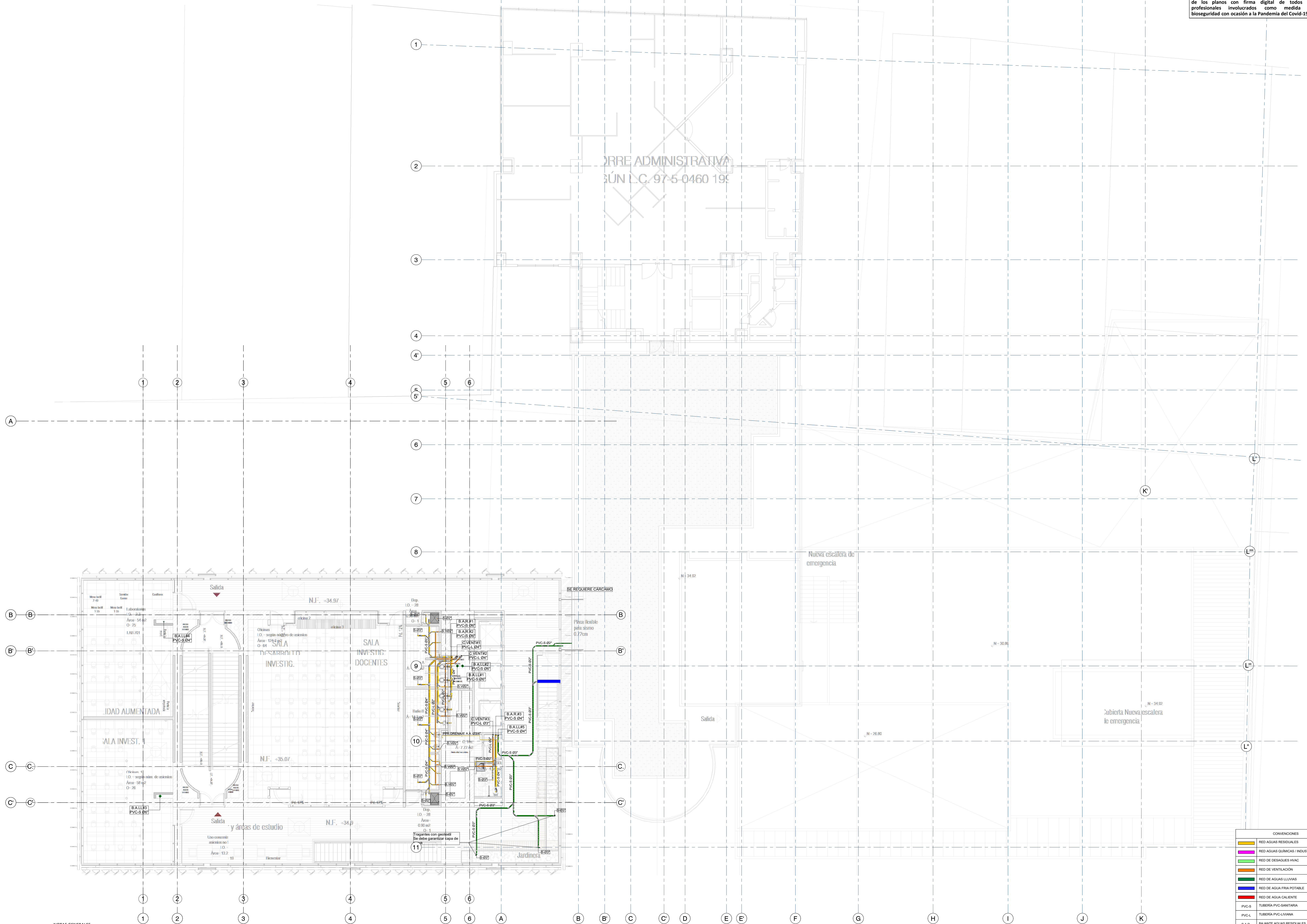
1 RED DE DESAGÜES DE AGUAS RESIDUALES Y AGUAS LLUVIAS NIVEL 7 1 : 100
